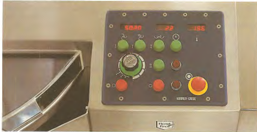
Die Digitalleuchtziffern links oben auf dem Kommandopult zeigen Messerwellendrehzahl, in der Mitte Zahl der Schüsselumdrehungen und rechts Brättemperatur an.
